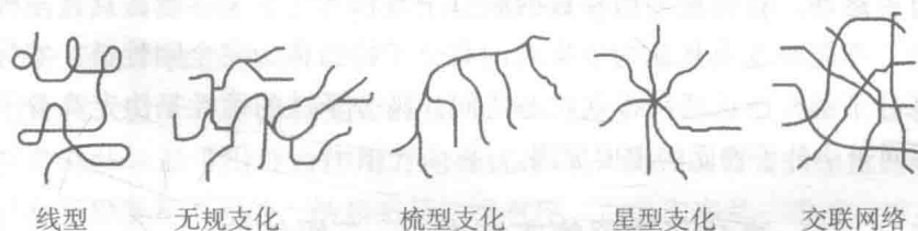
图 1-1 高分子链的支化与交联结构示意图
