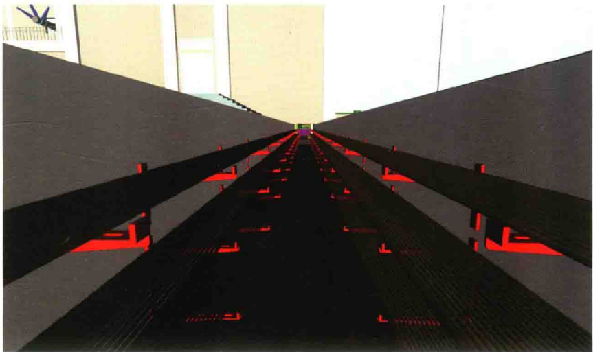
图 1-10 电缆沟电缆标号及走向图
