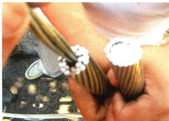
图 2-1 中强度节能导线与钢芯铝绞线
