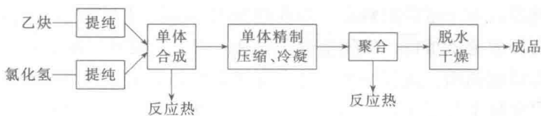
图 1-1 乙炔法制取聚氯乙烯示意图
