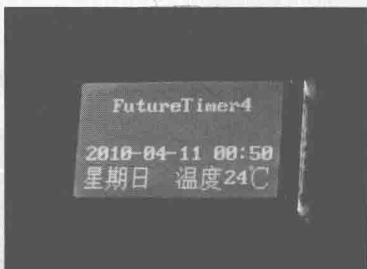
图 5 屏幕上显示的节日和时间信息。在不同光线下背光会自动调整
