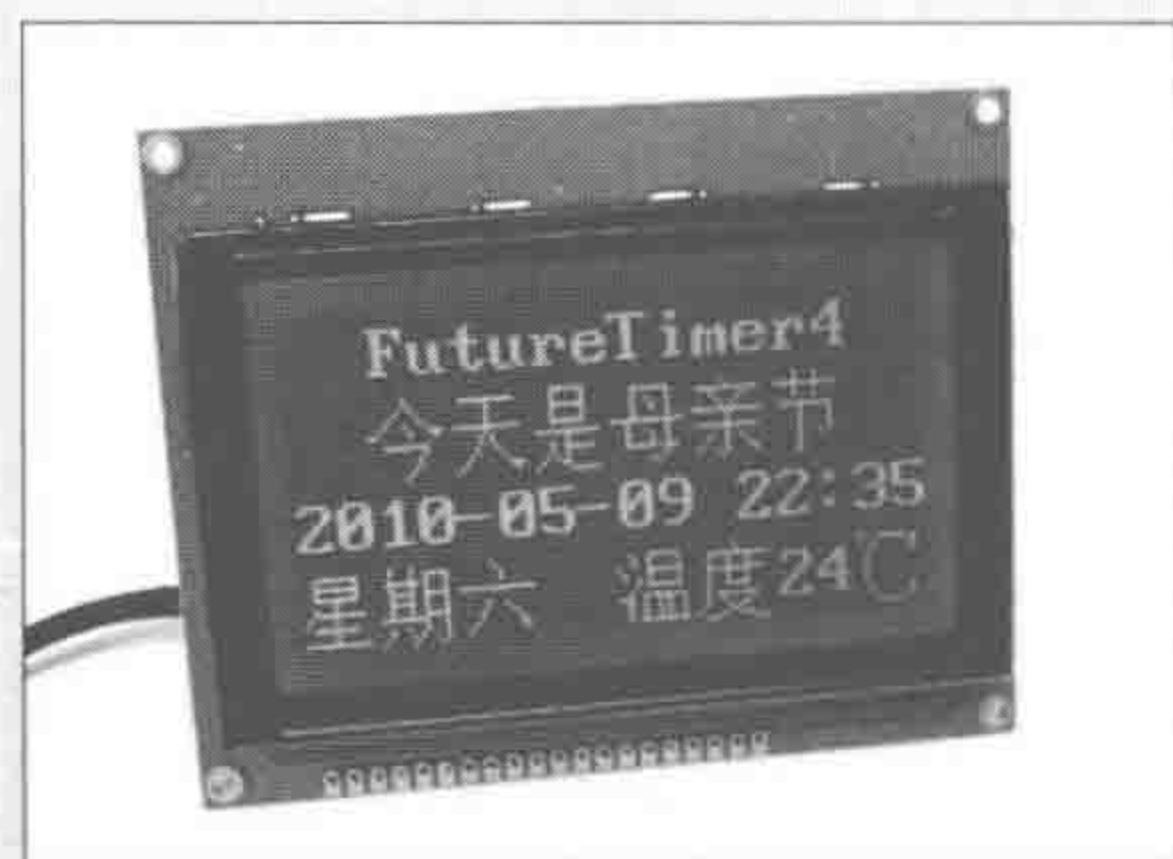
图 5 屏幕上显示的节日和时间信息。在不同光线下背光会自动调整
