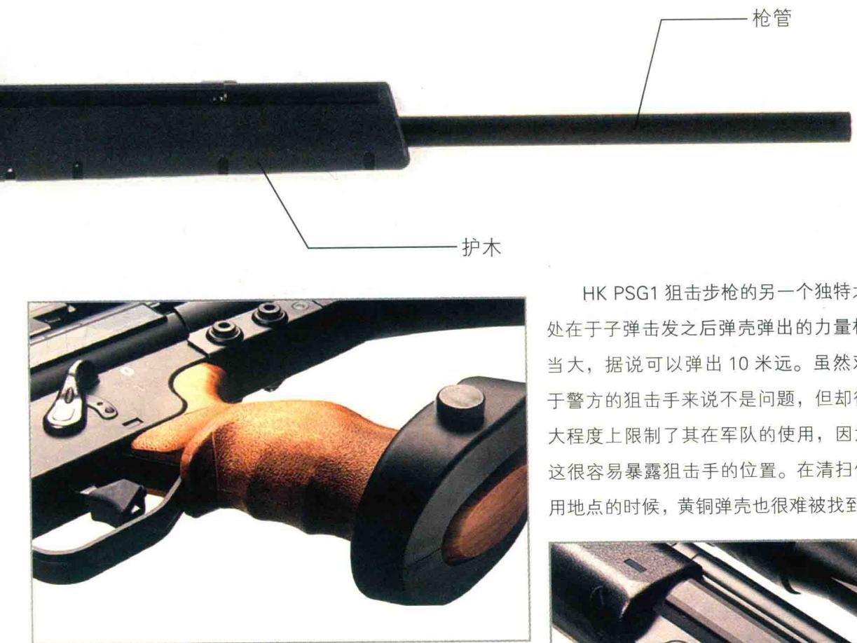
所有的HK PSG1狙击步枪都没有机械瞄准具，而是装备有照明分划板的Hensoldt 6×42瞄准镜，浮动重型枪管和可调节枪托。HK PSG1狙击步枪的枪托是由高密度塑料制成，外表为黑色粗糙表面，并且可以调向任何角度，以适合所有使用者的需要。它可以调整长度、可旋尾盖和调节托腮板的高低。前端还装置了一个T形槽，以配合旋转挂带或三脚架。该枪还有一个可以拆卸调整的扳机部件。扳机的行程可以调整，也可以从扳机护圈中拆下。
