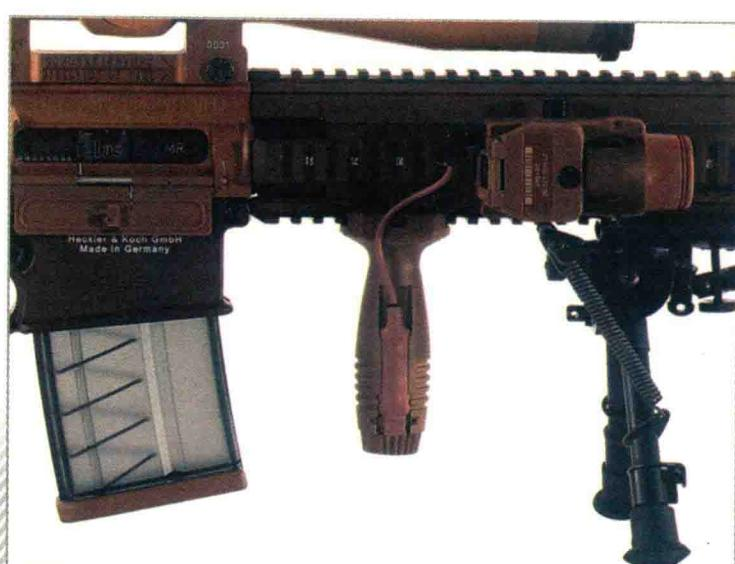
HK G28 狙击步枪使用了 STANAG 4694 北约配件导轨，该导轨接口系统可以与 STANAG 2324 或 MIL-STD-1913 战术导轨配件兼容。HK G28 狙击步枪约 120 件 (75%) 的零部件可以与 HK417 突击步枪通用。
