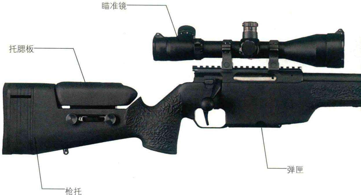
SIG SSG 3000 狙击步枪的枪管由碳钢冷锻而成，枪管外壁带有传统的散热凹槽，而枪口位置带有圆形凹槽。这样不仅能够散热，防止枪管因射击过热而变形，也能减轻重量和保证枪管的强度，对射击精度也有利。SIG SSG 3000 狙击步枪可在枪管上面连上一条长织带并遮蔽在枪管上方，其作用是防止枪管在暴晒下发热，上升的热气在瞄准镜前方产生视线干扰，妨碍射手进行精确瞄准。
