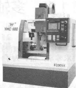
图 1-2 典型的四轴联动数控机床
