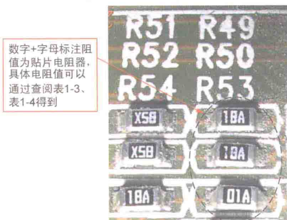
■ 图 1-9 数字 + 字母标注阻值的贴片电阻
