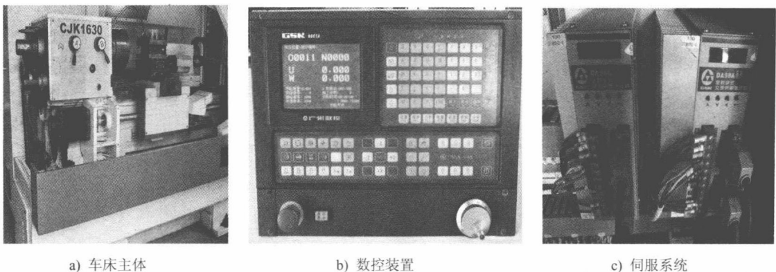
图 0-2 数控车床三大组成部分
