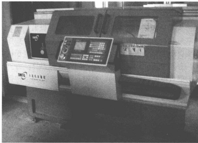
图 0-6 数控车床(广州数控系统 GSK980TD)
