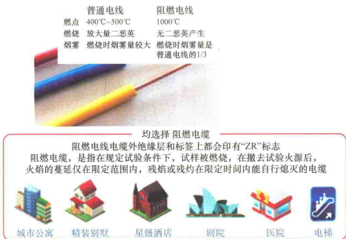
图 1-15 阻燃电线与普通电线的比较图例
