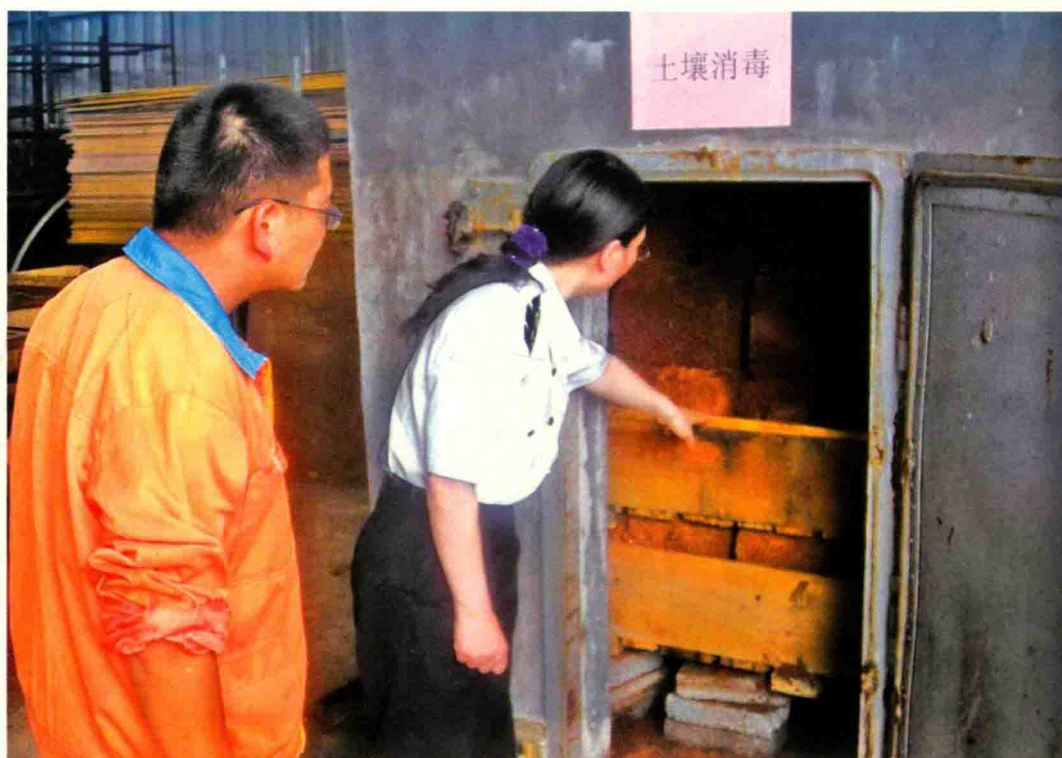
图 13 介质热蒸汽消毒设施（消毒窑）
