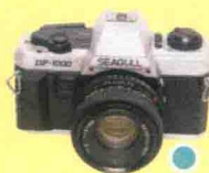
Seagull DF-1ETM 上海照相机总厂于1984年研制生产，1985年投放市场。该机是在海鸥牌DF-1型照相机基础上，移植海鸥牌DF-3型照相机的TTL电子测光系统，改动了结构，以硅光电二极管（SPD）全开光圈测光，集成电路（IC）运算控制，发光二极管（LED）做快门显示，是典型的半自动曝光照相机。该机早期称DF-104型，1986年改换测光接口后称1ETM型。
