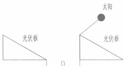
图 2-1 光伏板间距示意
