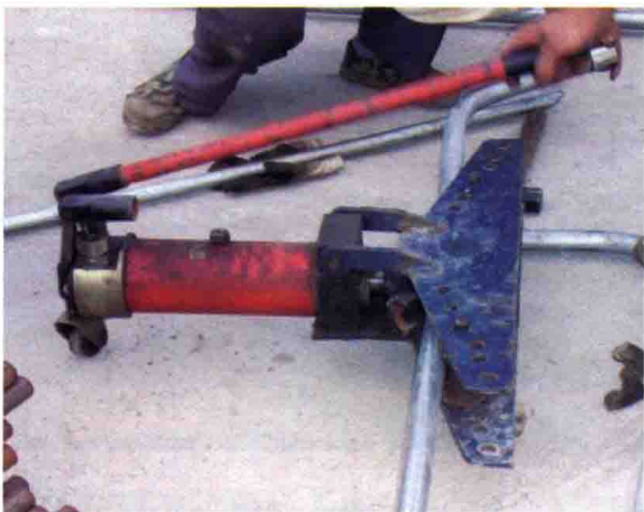
图 5.3-2 使用液压煨管器弯曲管路
