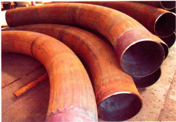
图 5.3-4 定制的大管径异形管弯
