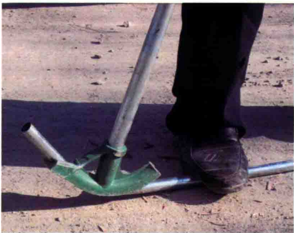
图 5.3-1 使用手动煨弯器弯曲管路
