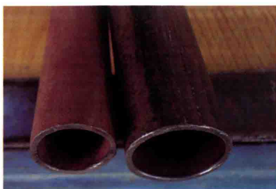
图 5.2-2 管口光滑无毛刺、切口端面平齐
