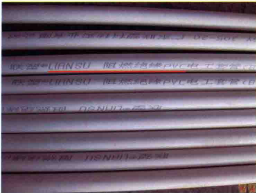
图 2.3 PVC 导管表面阻燃标记
