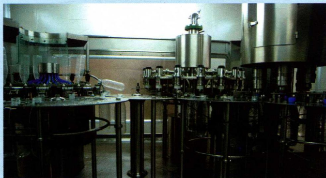
县中华山矿泉水厂瓶装水自动生产线
