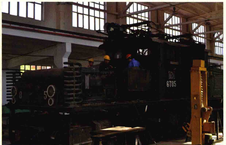
分公司煤炭运输实现了由蒸汽机车到内燃机车再到电力机车的三个历史阶段的提升。图为铁路运输部的电机车正在整修。
