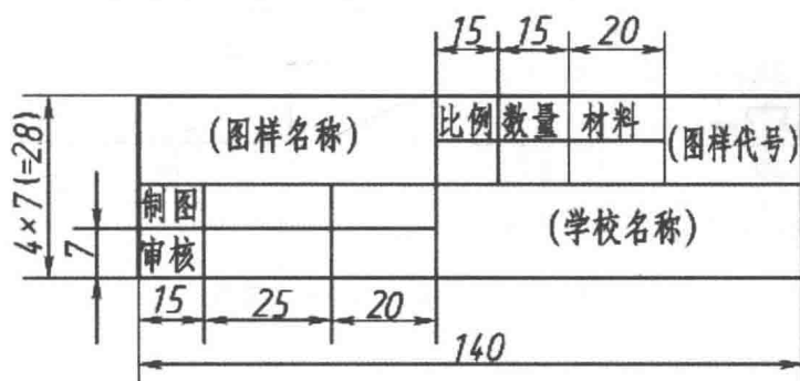
图 1-4 制图作业中的标题栏格式
