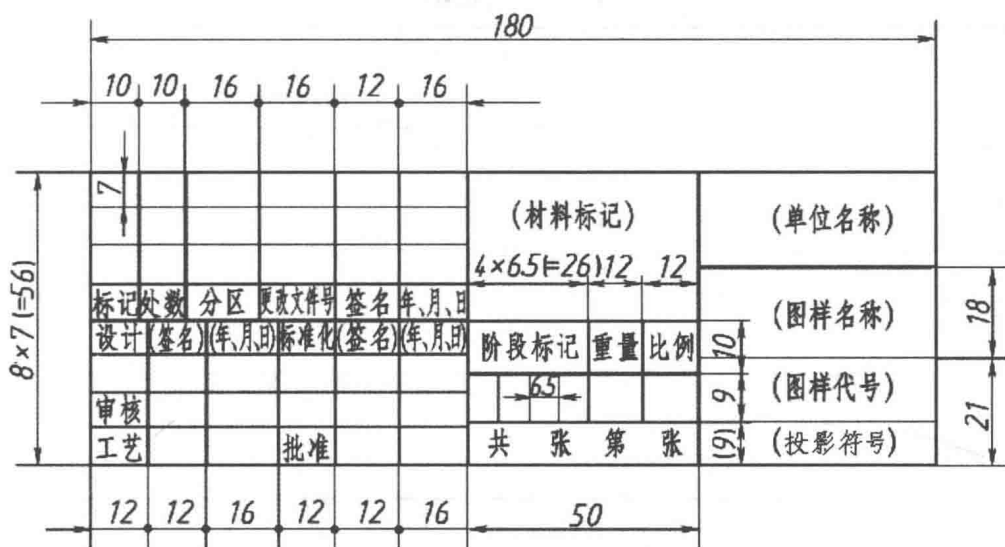
图 1-3 国标规定的标题栏格式
