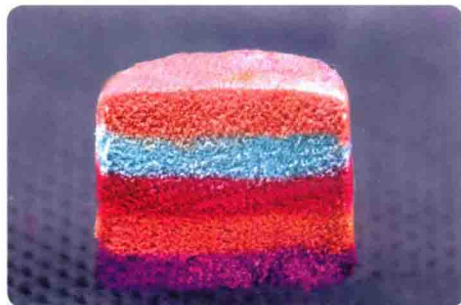
图1-15 纵切检查断面瓷层情况
