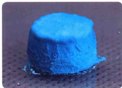
图1-12 堆塑形成圆柱体
