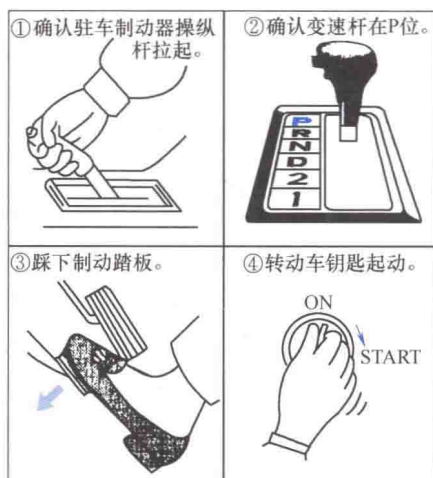
图 1-5 自动档汽车发动机起动步骤
