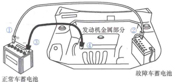
图 1-4 跨接电缆启动方法
