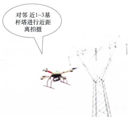
图 1-1 小型无人直升机巡检方式
