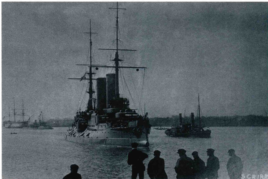
上图：1913年，俄国铁甲舰“皇太子（Tsesarevitch）”号对英国的朴茨茅斯港进行了一次友好访问。铁甲舰的装甲、艏鱼雷发射管及内倾式船舷在图中都清晰可见
