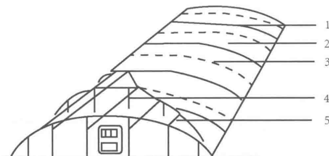
图 1-2 塑料大拱棚的基本结构
