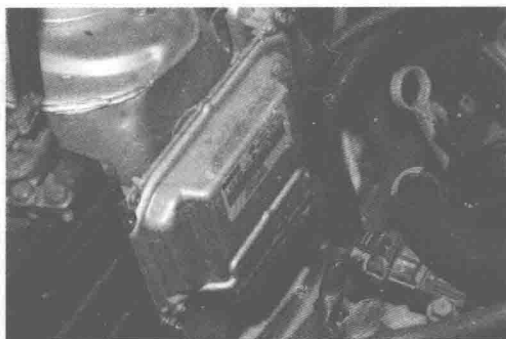
图 2-1 五菱荣光发动机控制单元的外形
