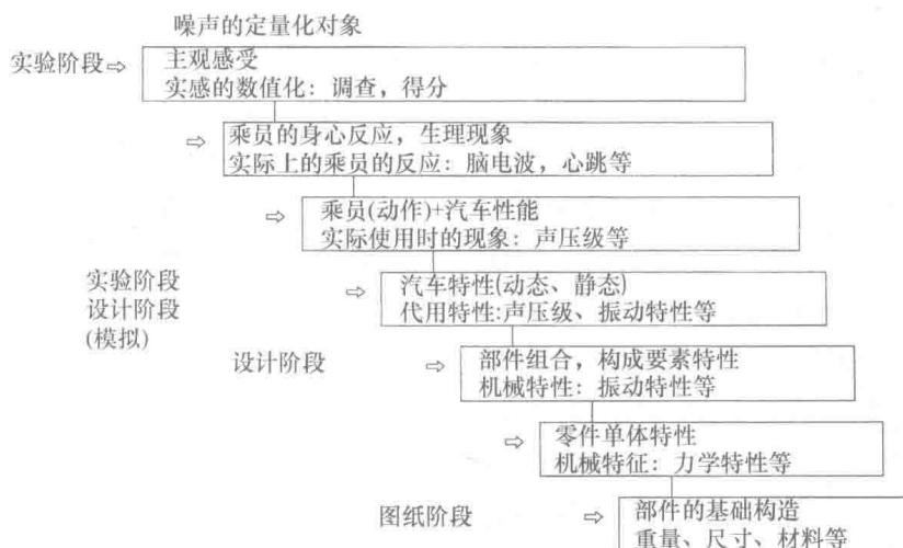
图 2-1 汽车噪声改进流程中的主观感受的量化
