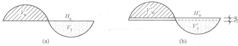
图 1-6 设计标高调整计算图 (a)理论设计标高; (b)调整设计标高
