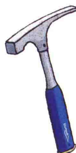
地质锤 方头的一端用于敲击凿子，平嘴的一端用于挖掘
