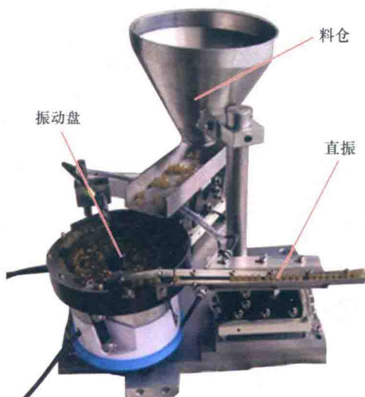
图 1-20 典型的自动化供料装置
