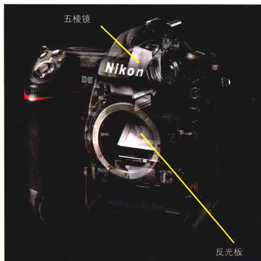
▲数码单反相机的核心部件：反光板和五棱镜（二）
