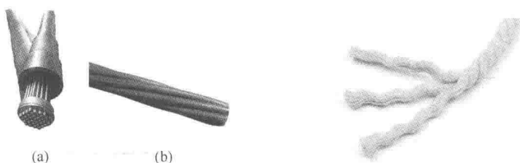
图1-7 平行钢丝索和平行钢绞线索 图1-8 三股绞编绳结构 (a) 平行钢丝索;(b) 平行钢绞线索。
