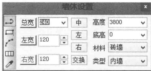
图 1-6 直接创建墙体
