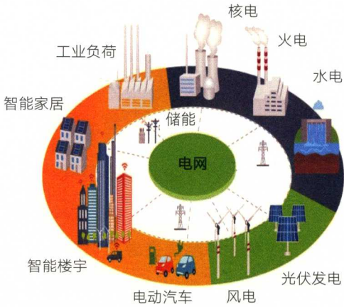
图 1-5 涵盖源－网－荷－储的电力系统
