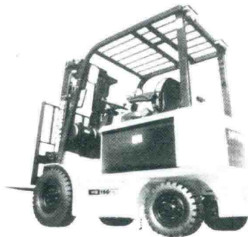
图 1-4 1.8t 平衡重式电动叉车
