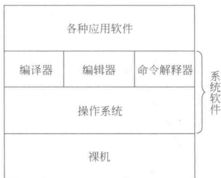
图 0-1 计算机系统的软件和硬件
