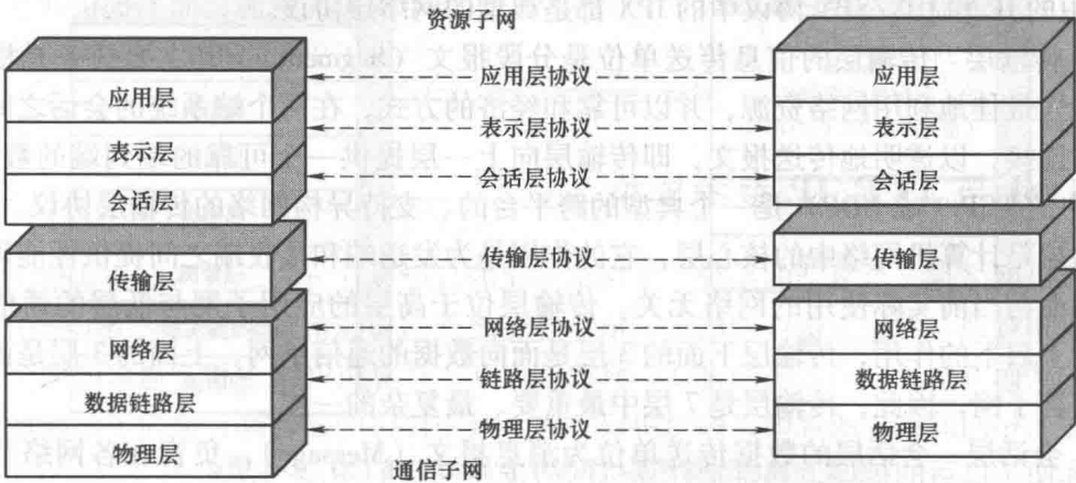
图 1-2 OSI 参考模型的分层结构
