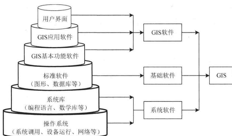
图 1.3 桌面 GIS 系统架构
