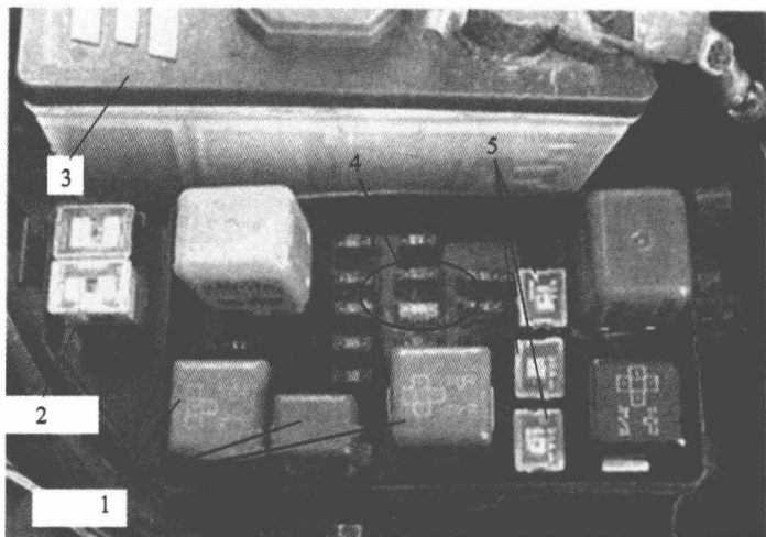
图 1.18 中央接线盒中的熔断器
