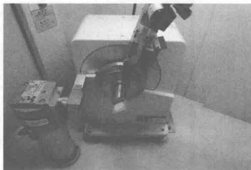
图 2-4 放入样品的 XRD 样品室
