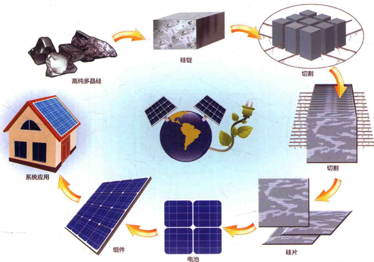
图 2 晶体硅光伏制造流程
