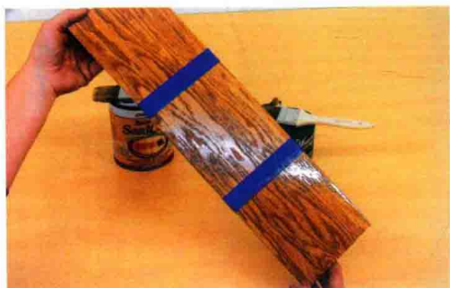
图 1.2 阶段样板是一种更复杂的测试样板，可以展示涂装的每个阶段。
