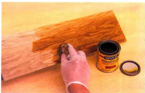
图 1.1 制作测试样板可以很简单, 主要工序包括在木材面板上打磨、上色漆和涂面漆。
