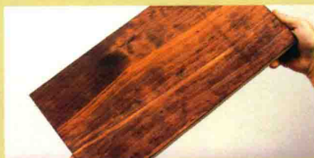
图 1.3 在制作样板时要避免过度操作也要避免操作不足。制作样板的目的是在成品上重现样板的效果。
