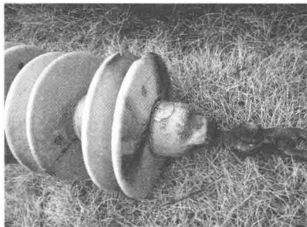
图 1-2 有放电痕迹的绝缘子
