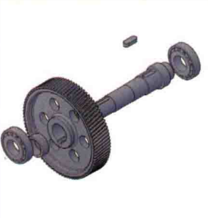
减速器齿轮组件装配
