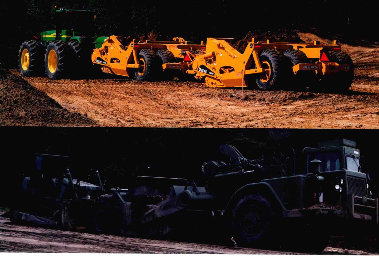
铲运机最有特点的地方是它有一个像铲子一样前部非常尖利的铲斗。铲运机的作用非常大，它自己就能够完成挖土、运土、卸土、填筑、整平地面的工作，而且铲运机非常灵活，在任何地方都可以工作，工作效率很高。
