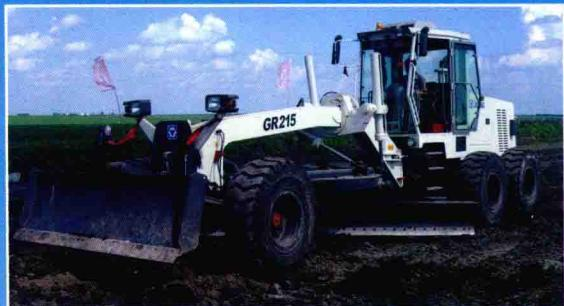
在平地机的前面或前后轮轴之间有一把锋利的铲刀，它可以将不平坦的地面铲平整。平地机主要用于构筑路基和路面、修筑边坡、开挖边沟，也可以用于搅拌路面混合料、扫除积雪、推送散粒物料以及进行土路和碎石路的养护工作。
