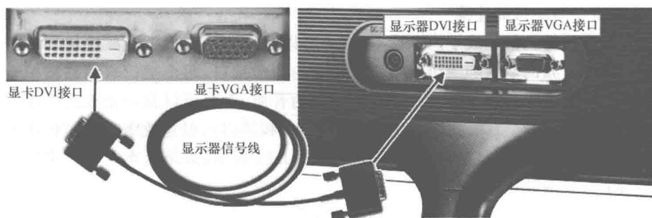
图 1-7 显示器与主机之间的连接示意图
