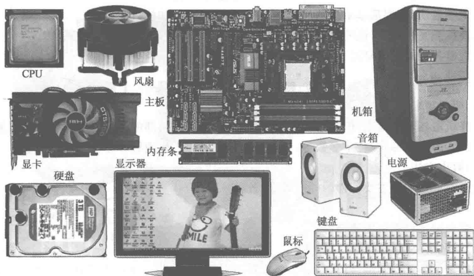
图 1-4 台式微型计算机中的主要部件示意图
