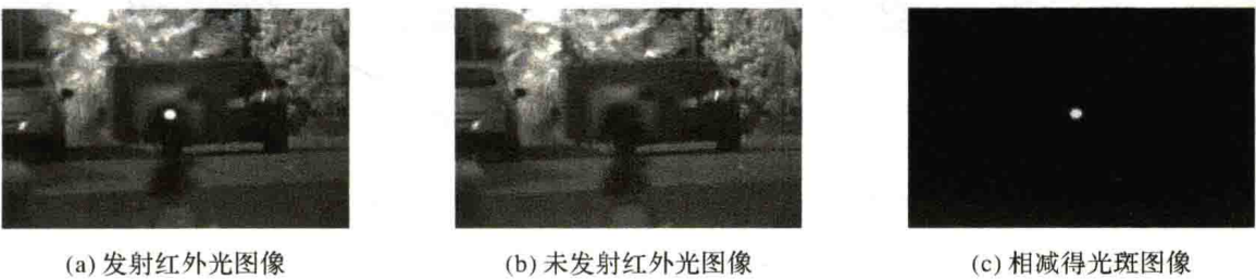
图7 自动目标识别系统红外光前后相减效果
