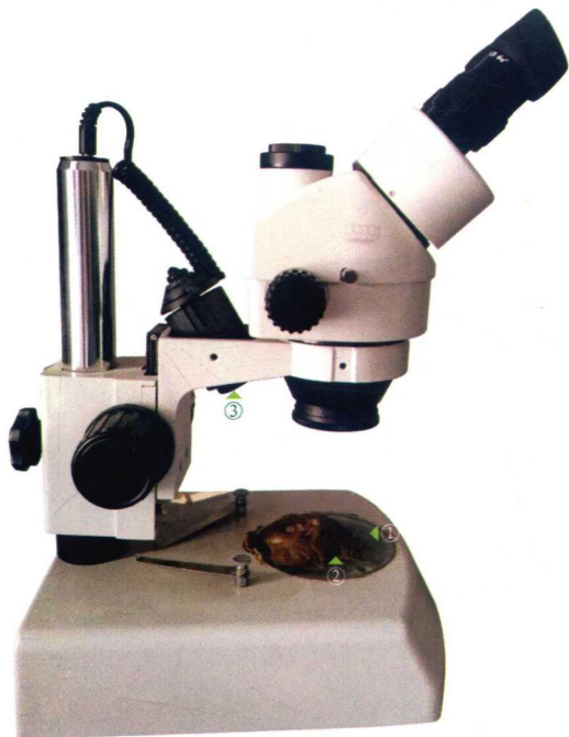
图 1-1 可用于花的精细解剖和结构观察的一种解剖镜（XZT-DT 型，SOIF）
