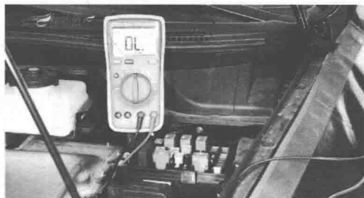
图 1-1-12 打开万用表旋至蜂鸣挡
