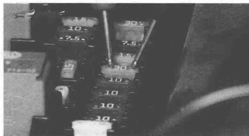
图 1-1-14 检测熔断丝是否导通(2)
