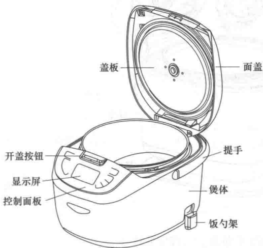
图 1-4 康佳电饭煲 KRC-40ZS26 结构与维修（一）
