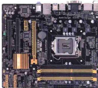
电脑的主板采用了开放式结构。主板上大都有6至15个扩展插槽，供电脑外围设备的控制卡(适配器)插接。通过更换这些插卡，用户可以对电脑的相应子系统进行局部升级。
