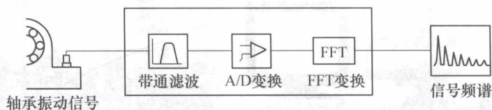
图 1-6 轴承振动信号测量
