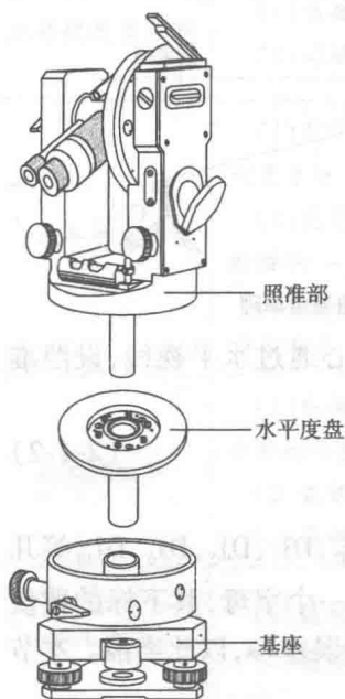
图 1-2-4 DJ 6 光学经纬仪的组成部分
