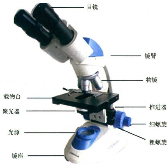
图 1-1 显微镜的基本结构
